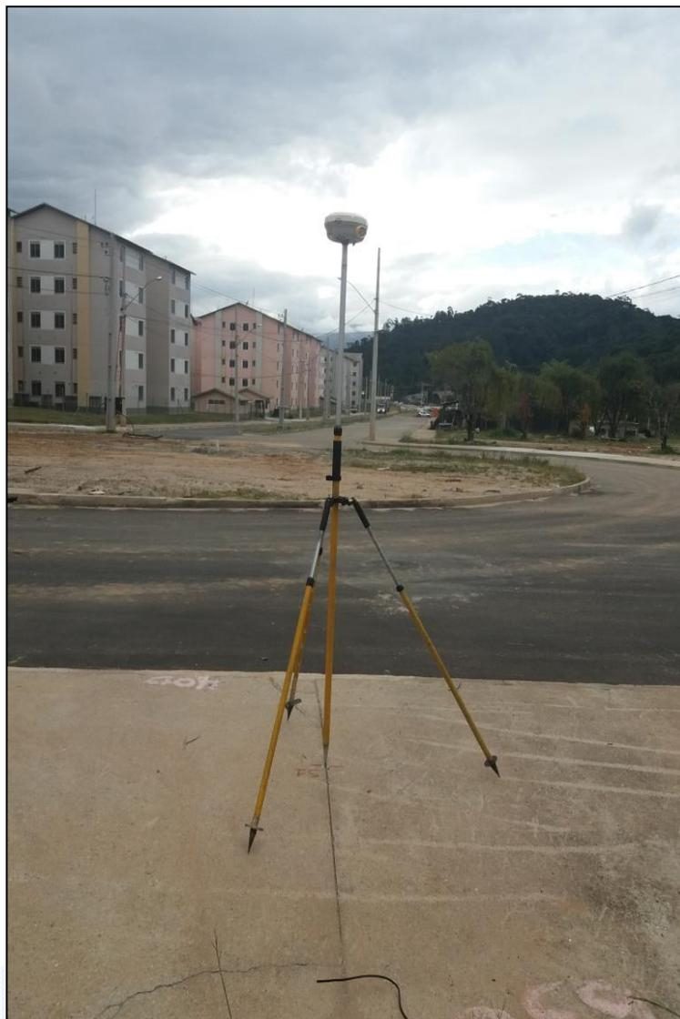
**SERVIÇO:** IMPLANTAÇÃO DE DUAS ESTAÇÕES GPS PARA APOIO TOPOGRÁFICO.
