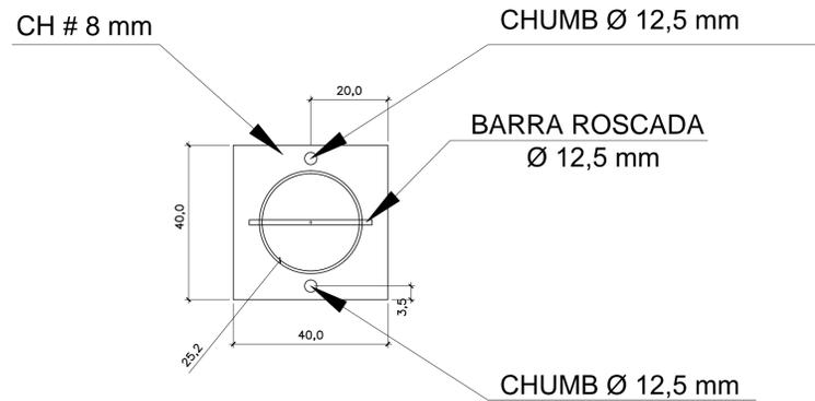
DETALHE 1 - FIXAÇÃO PILAR
