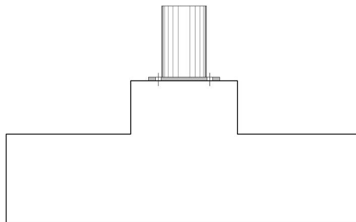
DETALHE 1 - FIXAÇÃO PILAR
